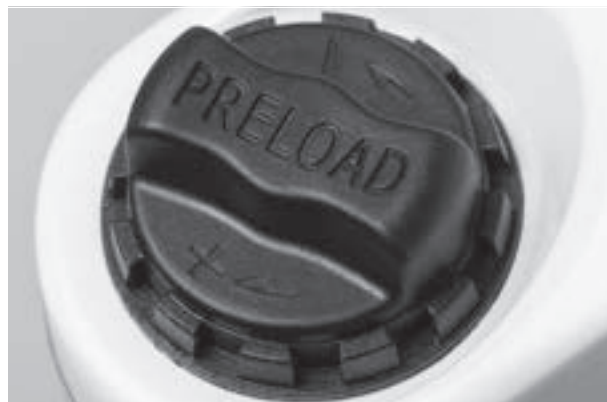
Figura 44: Rueda de ajuste del recorrido de muelle negativo en la corona de la horquilla de suspensión
