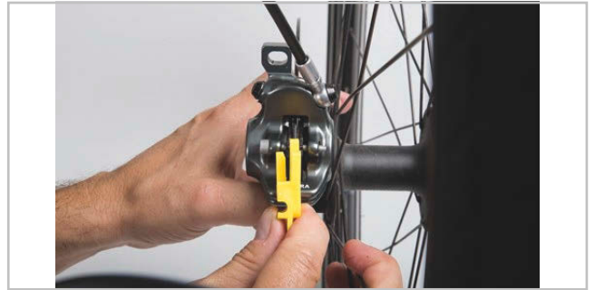
Afbeelding 51: Remvoering in gemonteerde toestand controleren met behulp van de transportbeveiliging
