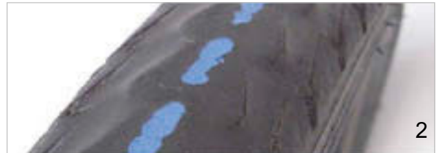
Afbeelding 49: Een band zonder profiel, die kan worden vervangen (1) en een band met zichtbare anti-leklaag (2), die moet worden vervangen
