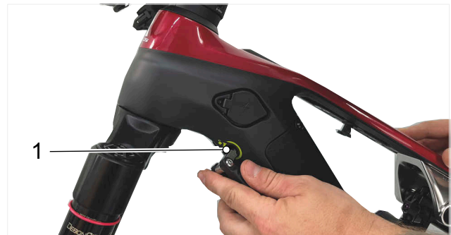
Afbeelding 35: Accuslot met inbusgereedschap openen
