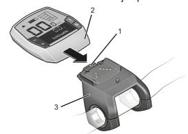
Illustration 34 : Enfoncer l'écran (2) via le dispositif de blocage de l'écran (1) jusqu'à la butée du support (3)
