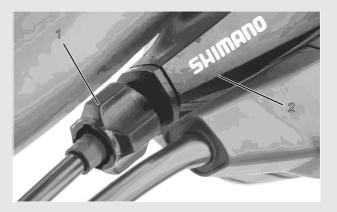
Illustration 41 : Douille de réglage (1) du changement de vitesse à un câble actionné par câble avec boîtier de manette de vitesse (2), exemple
