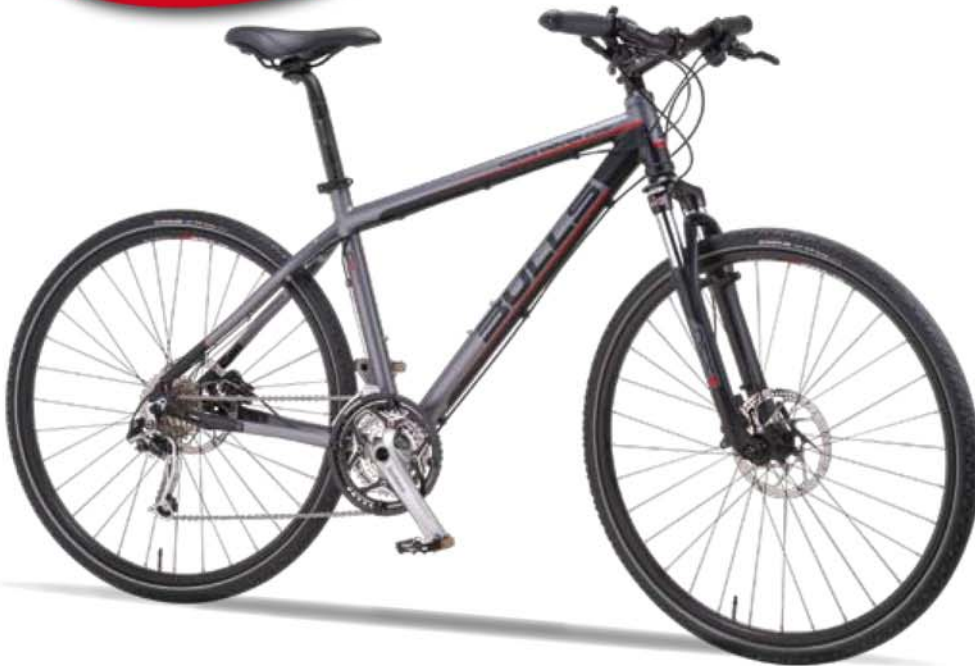
Ungewöhnlich groß: 180er Brems-scheibe für sichere Verzögerung
