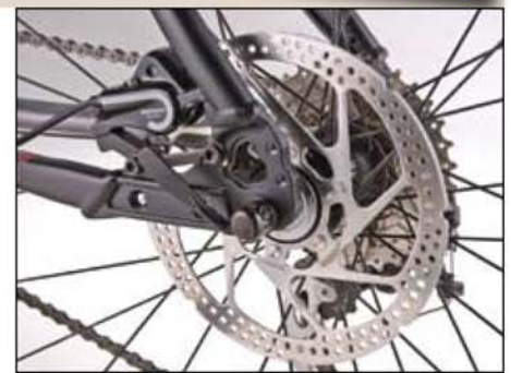
Ungewöhnlich groß: 180er Brems-scheibe für sichere Verzögerung
